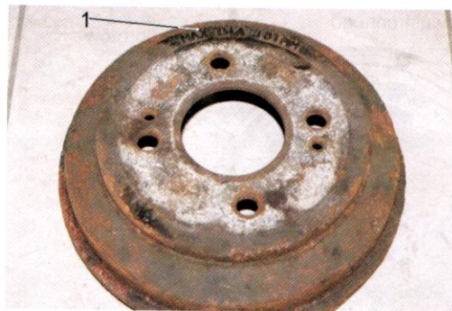
Rys 4.9 Bęben hamulcowy [52]
