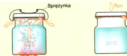
1 Działanie ciśnienia powietrza przy wekowaniu przetworów
