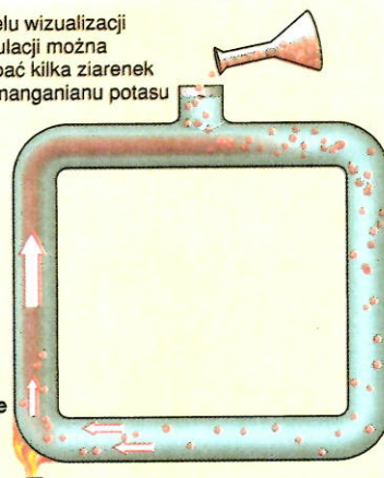
2 Przenoszenie ciepła w cieczach za pomocą napędu cieplnego (termika) lub przez siły mechaniczne
