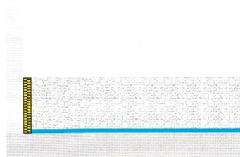
Rys. 3.2. Podkład zespolony – styk z podłożem przez mostek szepny
