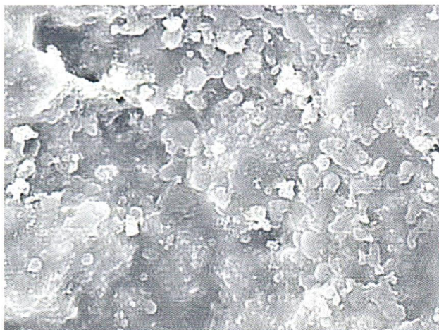
Rys. 4.2. Budowa strukturalna kamionki (widok pod mikroskopem elektronicznym)
