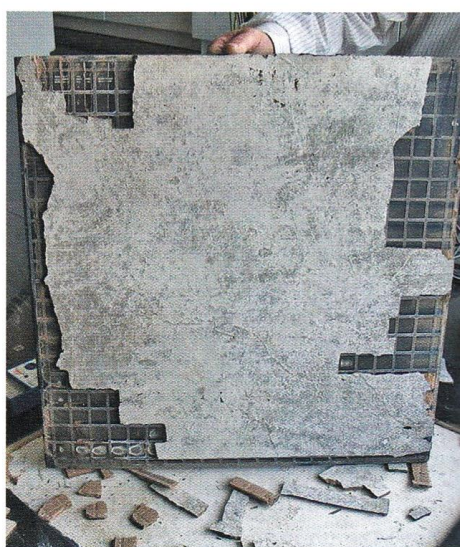
Rys. 4.11. Odspojenie okładziny razem z warstwą uszkodzonego podkładu
