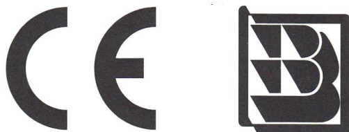
Rys. 4.9. Oznaczenie produktu spełniającego wymagania zgodności produktu z normą europejską i znak budowlany B
