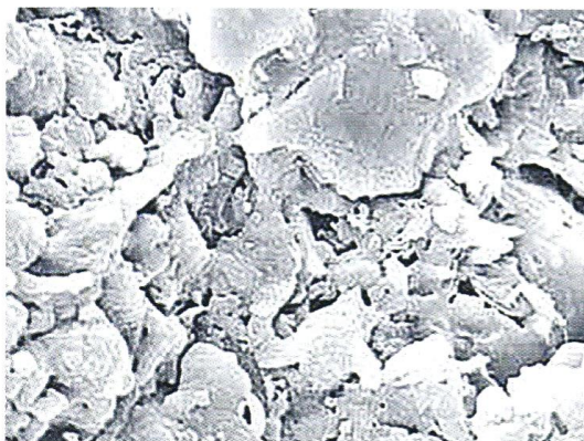
Rys. 4.1. Budowa strukturalna glazury (widok pod mikroskopem elektronicznym)
