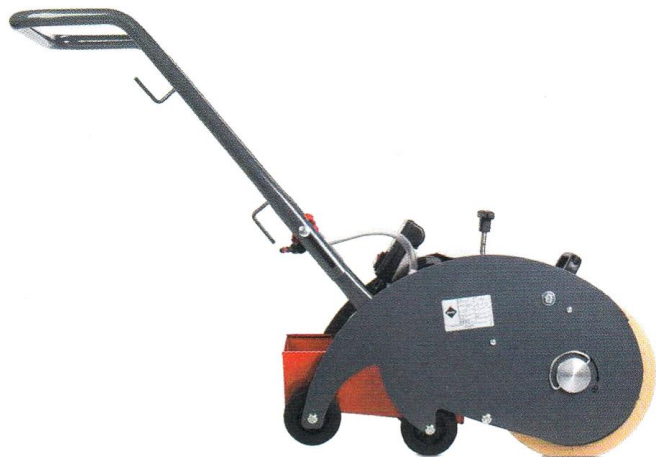
Rys. 4.47. Elektryczna maszyna do zmywania fug
