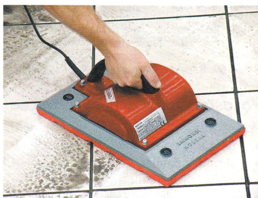
Rys. 4.65. Wibrator ręczny
