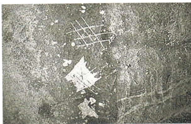
Rys. 4.89. Ocena nośności powierzchni przez wykonanie testu na zarysowanie
