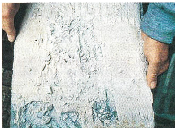
Rys. 4.88. Utrata przyczepności spowodowana utworzeniem się etryngitu
