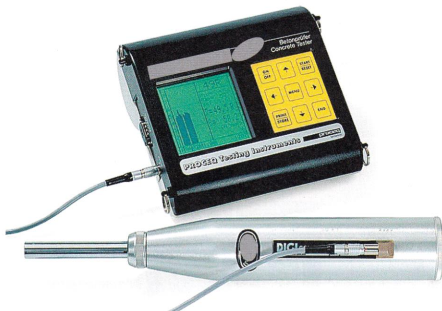
Rys. 5.5. Młotek Schmidta wykorzystywany podczas badań sklerometrycznych
