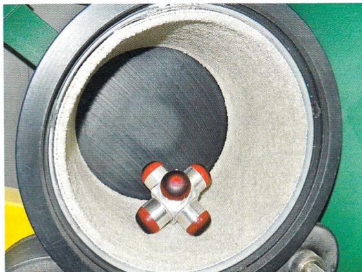
Rys. 6.4. Urządzenie wykorzystywane do przeprowadzania testu Vettermana
