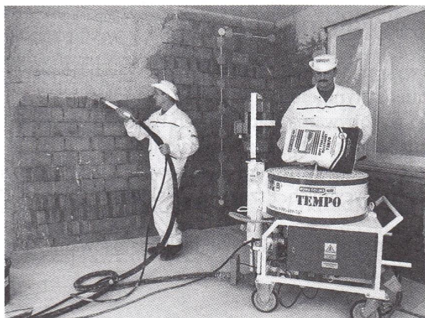
Rys. 1.2. Agregat do mechanicznego wykonywania tynków gipsowych
